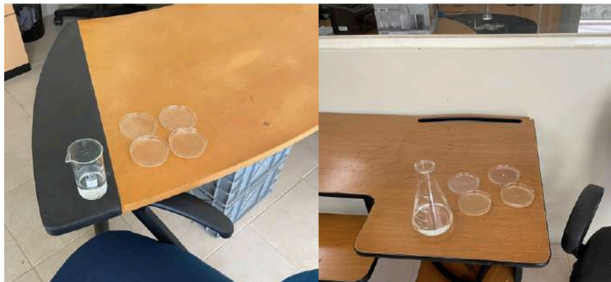
Imagen 1. Se observan la ubicación de los recipientes con Solución de Bioxydes Plus y junto a estos, se situaron las placas con los medios de cultivo para la recuperación de bacterias y hongos.
