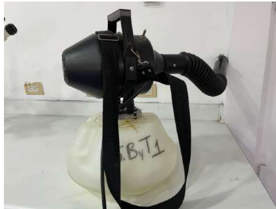
Imagen 9. Nebulizador eléctrico utilizado para la desinfección con la solución de Dióxido de Cloro (Bioxydes Plus).
