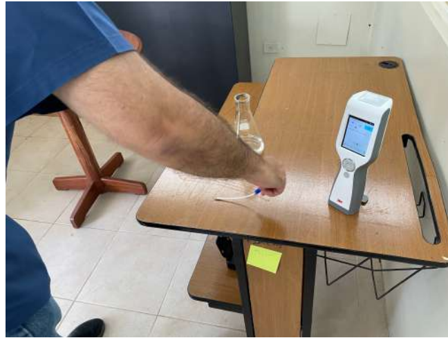
Imagen 4. Punto 1 ubicado en la oficina de la Coordinación de Acuicultura de la FIMCM, donde se tomó muestra con un hisopo y luego leído en un luminómetro Clean-Trace™.
