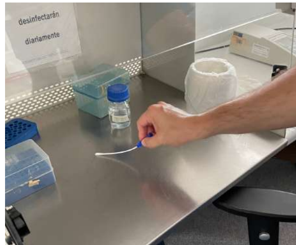
Imagen 6. Toma de muestra de la superficie de la cámara de flujo laminar del laboratorio de Patología, FIMCM-ESPOL.
