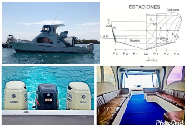
Figura 2. Lancha interisla modelo con 12 m de eslora y 3 motores fuera de borda totalizando 850 Hp.
